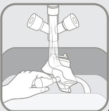
Le mécanisme du robinet doit être nettoyé à l'aide d'un chiffon humide et d'un détergent doux.
