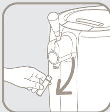
Après avoir installé la tireuse à bière BeerTender, il faudra procéder au nettoyage de l'embout de robinet, car c'est la seule partie de l'appareil en contact direct avec la bière.
